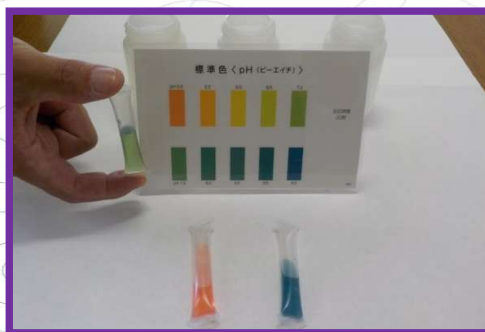
簡単で安全な水質分析（パックテストを使って身近な水の汚れを調べる）体験ができます
